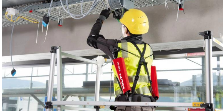
Şekil 5. İnşaat Alanında Giyilebilir Robotların Kullanımı (Hilti, 2022)
