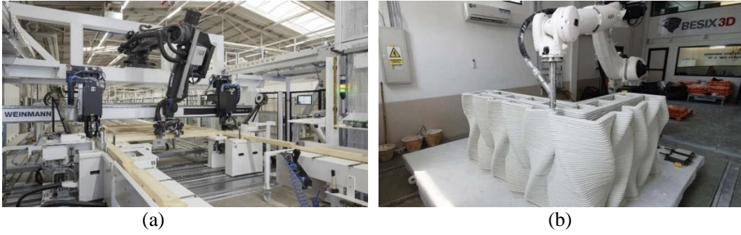
Şekil 2. (a) Prefabrik Üretim Sürecinde Otonom Robotlar (WeberHaus, 2023), (b) Saha Dışı Katmanlı Üretim Robotu (KR QUANTEC, 2022)
