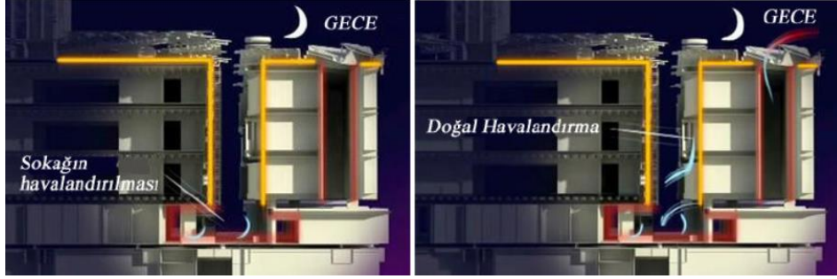
Şekil 7. Enstitü binası gece doğal havalandırma akış şemaları (URL-5)
