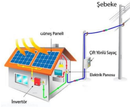
Şekil 4. Konutlarda PV panel sisteminin yerleşimi ( https://www.ostimaku.com )
