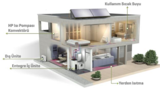
Şekil 5. Konutlarda ısı pompası sisteminin yerleşimi ( https://www.enerjivetesat.com )
