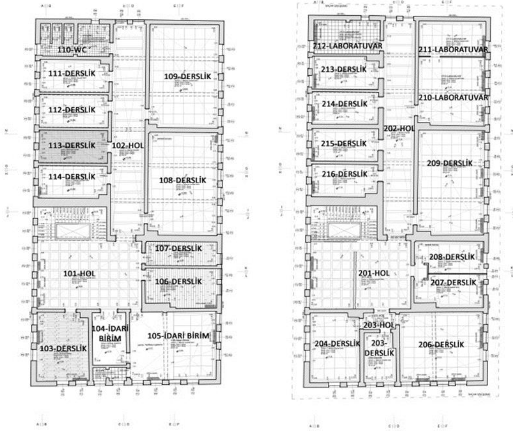
Şekil 3. Özgün yapının birinci ve ikinci kat rölöveleri
